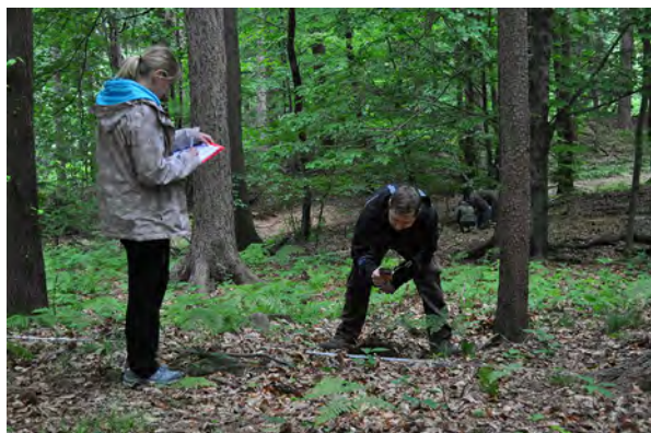
Izvajanje meritev magnetne susceptibilnosti vrhnjega sloja tal z instrumentom Kappameter KT-5/KT-7.
